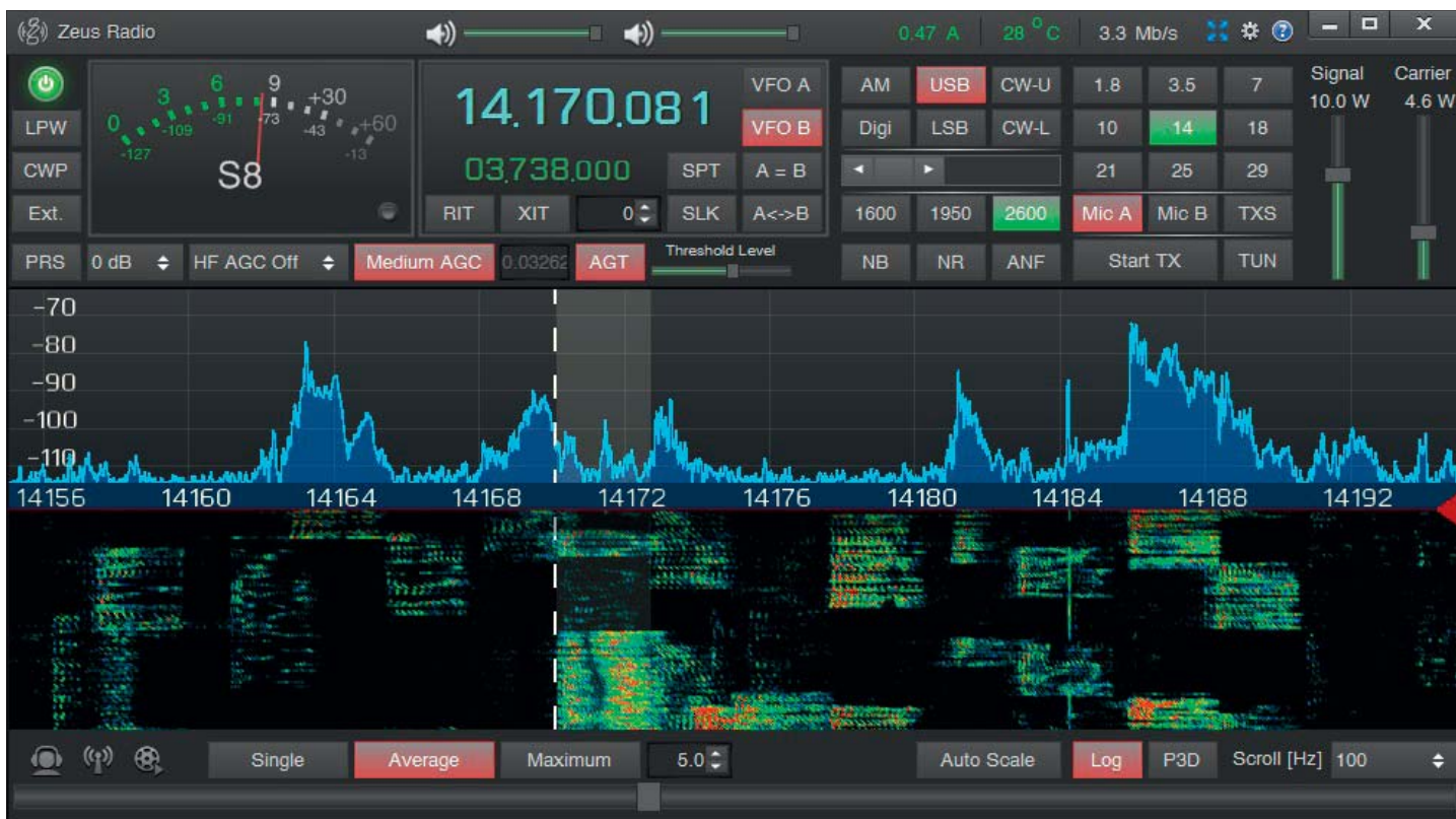
Bild 4, det grafiska gränssnittet för användaren är exemplariskt lätt och överskådligt. Vattenfall och spektrumvisning är dominerande. Men i övrigt mycket lätt att använda. Knappt så att manualen behöver anlitas.
